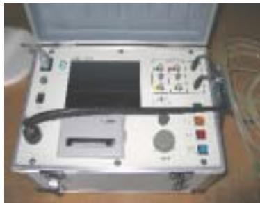
操作計測部 損傷・変形なし。
